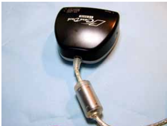
带Clamp Filter的读卡机
