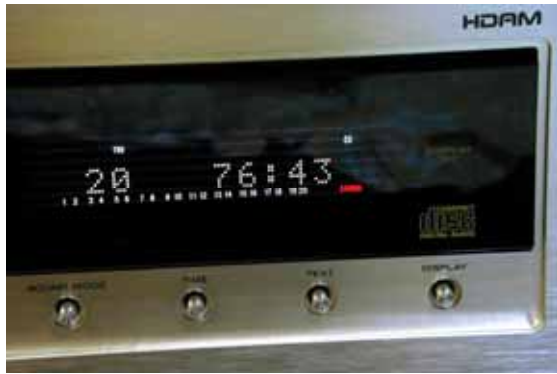
影响声音的CD唱机的显示器 (在某价位以上的CD唱机大多能够关掉)
